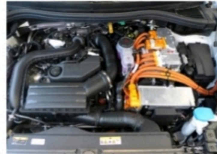
Cables de color naranja en el vano motor
