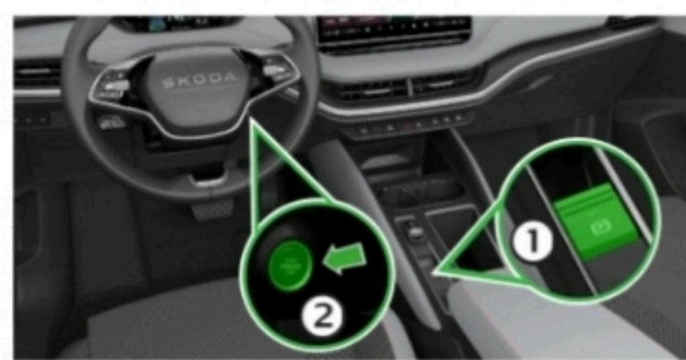
1. Accione el freno de estacionamiento electrónico.
