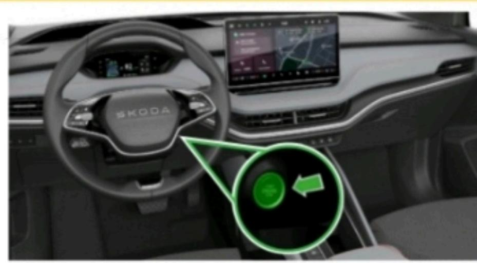
Pulse el botón «Engine Start/Stop» de la columna de dirección sin pisar el freno de pie.
