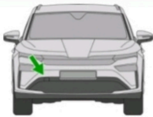
Anilla de remolque delantera en el lado derecho del vehículo
