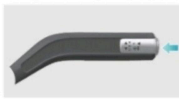
Pise el pedal del freno y presione el botón "P", el vehículo aplicará automáticamente el freno de estacionamiento.
