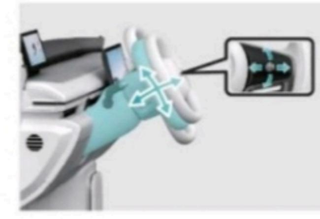
La columna de dirección tiene ajuste de inclinación y telescopico eléctrico o manual.
