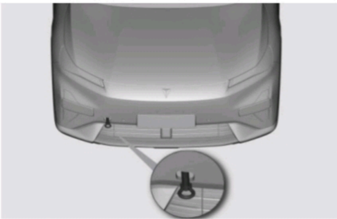
Ubicación de montaje del gancho de remolque
