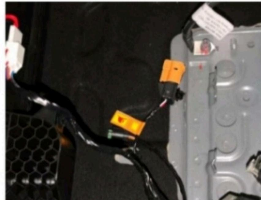
En caso de emergencia, el sistema de alta tensión puede aislarlo retirando el dispositivo de desconexión manual de servicio (dispositivo maestro de seguridad) ubicado en el compartimento de carga.
