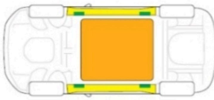
Puntos adecuados de elevación-estabilización.
