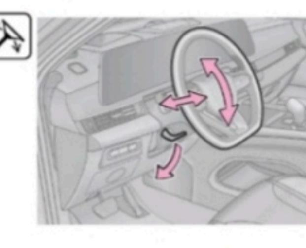
La columna de dirección tiene ajuste telescópico y de inclinación.
