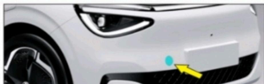
Abra la cubierta y utilice el gancho de remolque.
