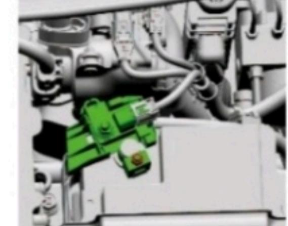
Desconecte el cable negativo (-) de la batería.
