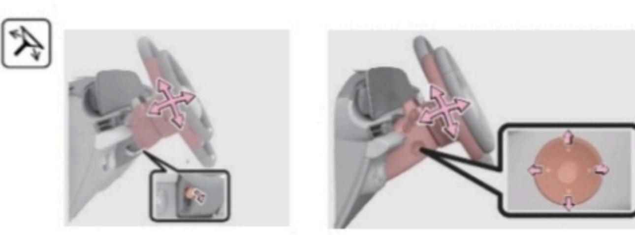
La columna de dirección tiene inclinación manual o manual y ajuste telescópico.
