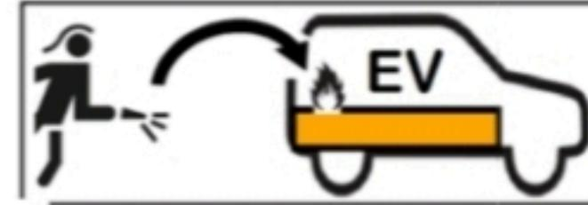
Sistema específico para meter agua en el interior de la batería de 400V.
