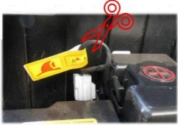
Corte el cable del conector de bloqueo de servicio para desactivar el sistema de AV.
