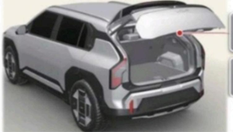
Retire la cubierta de la parte inferior del portón trasero y deslice a continuación el pestillo en la dirección de la flecha para desbloquear el portón.
