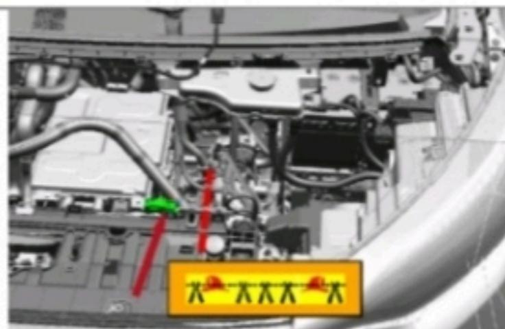
Paso 2: Desconexión de la batería de 12 V - Desactiva el sistema de retención de seguridad (SRS):
