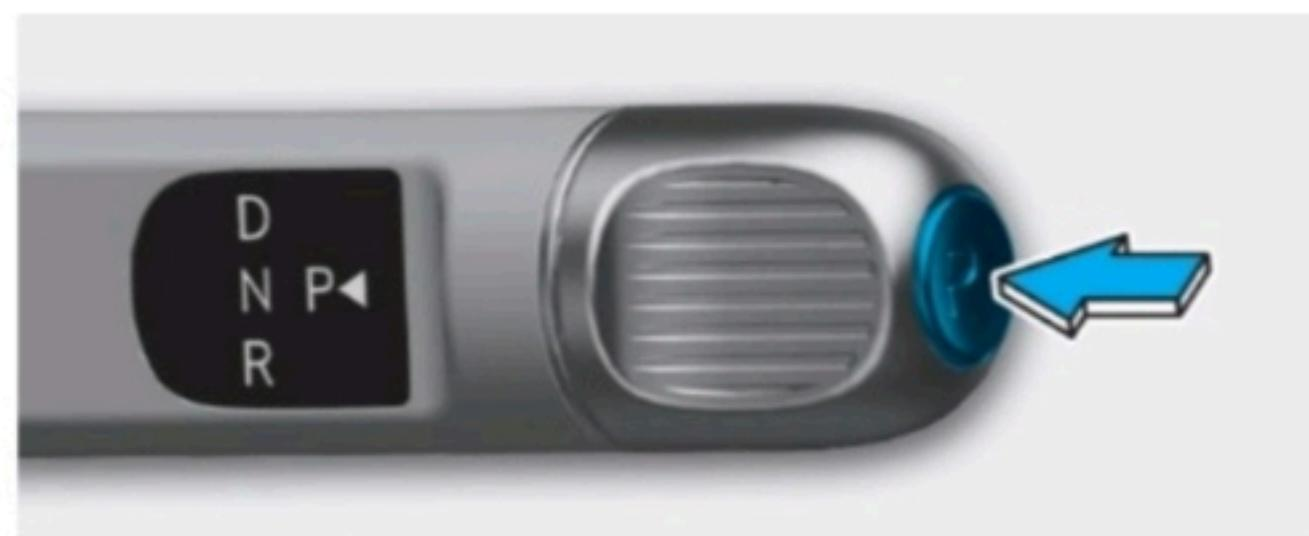
1. Calce las ruedas y tire del interruptor del freno de estacionamiento.
