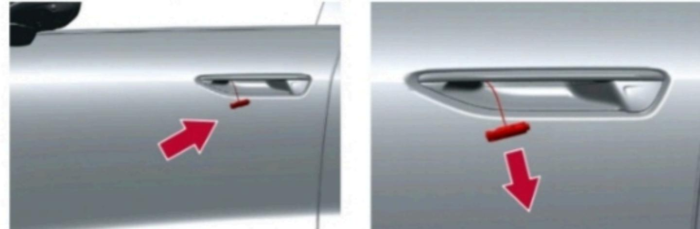
**En caso de accidentes con disparo de airbag se desbloquean las 4 puertas y ya solo se pueden abrir de forma mecánica. ¡Para ello, tirar del perno expulsado por el extremo del cable!**
