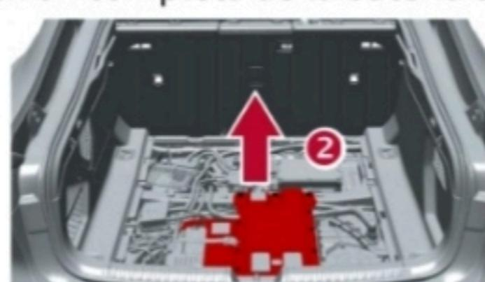
② Desmontar la cubierta de la batería.
