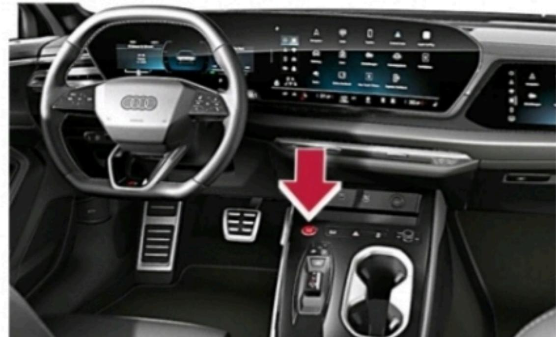
Pulsar la tecla "Start-Engine-Stop" situada en la consola central sin accionar el pedal del freno.
