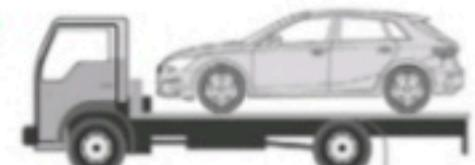
No remolcar un vehículo accidentado haciendo rodar los ejes de accionamiento.
