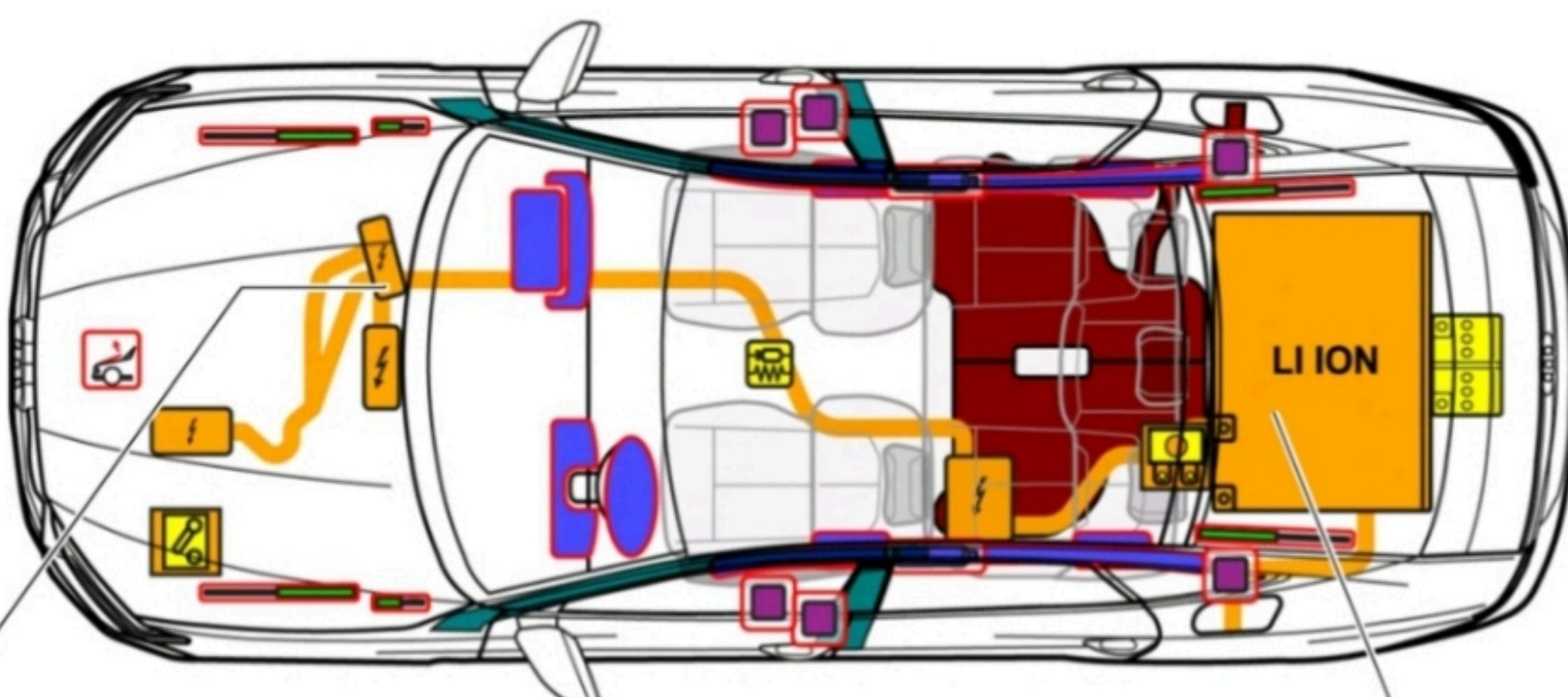
Componente de alto voltaje en el lado contrario en vehículos con volante a la derecha
