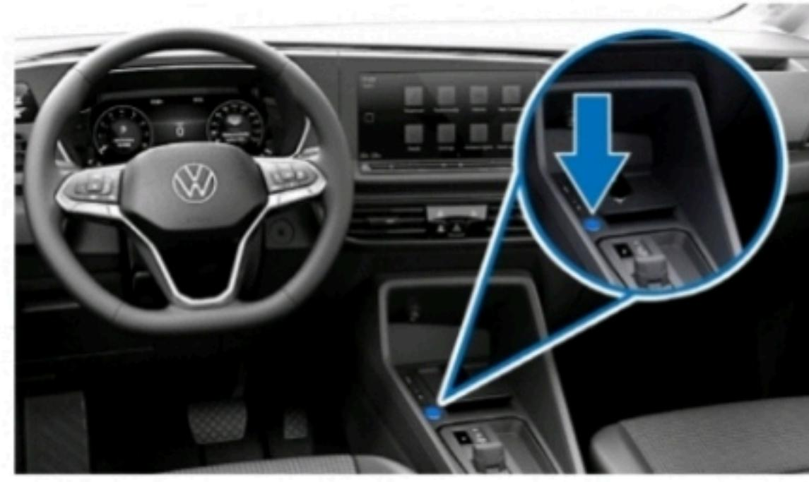
Pulsar la tecla "Start-Stop" de la consola central sin accionar el pedal del freno.
