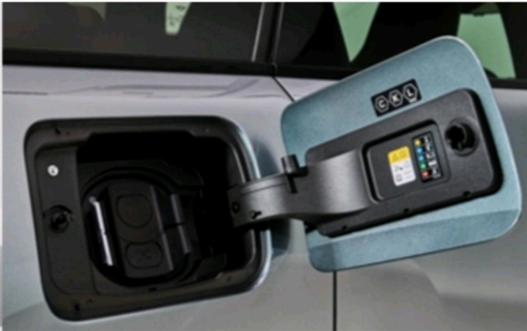
Conexión de carga de alto voltaje en la pared lateral trasera derecha
