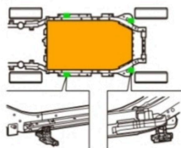
■ Puntos de elevación adecuados ■ Batería de alta tensión
