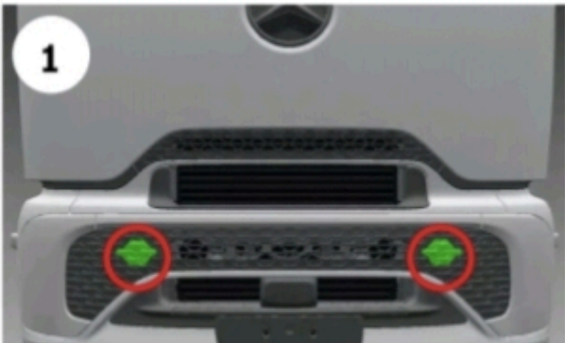
Retire las cubiertas del gancho de remolque
