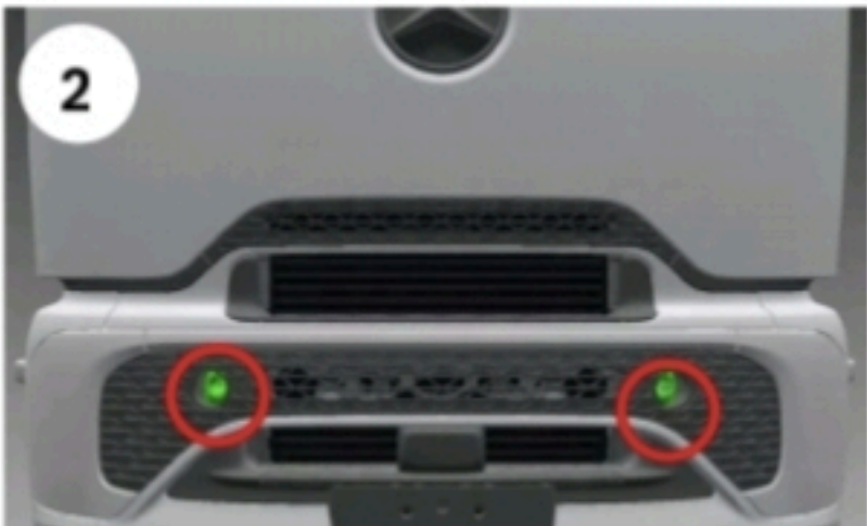
Coloque el gancho de remolque
