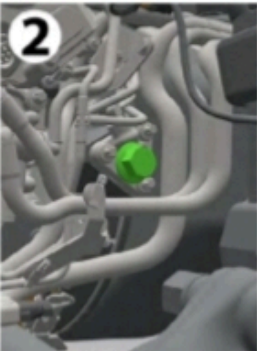
5. Monte el perno retirado del eje de accionamiento en el bloqueo del diferencial mientras gira las ruedas hasta que el bloqueo se bloquee.
