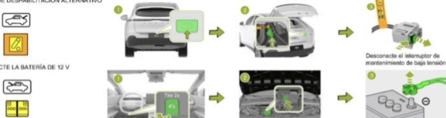
DESCONECTE LA BATERÍA DE 12 V
