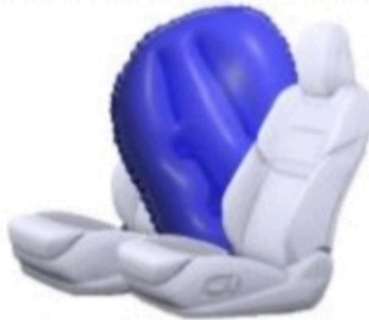
El asiento del conductor tiene una bolsa de aire lateral lejana además de la bolsa de aire lateral. La ubicación de la bolsa de aire lateral lejana se muestra en la marca 9. en la página 1.
