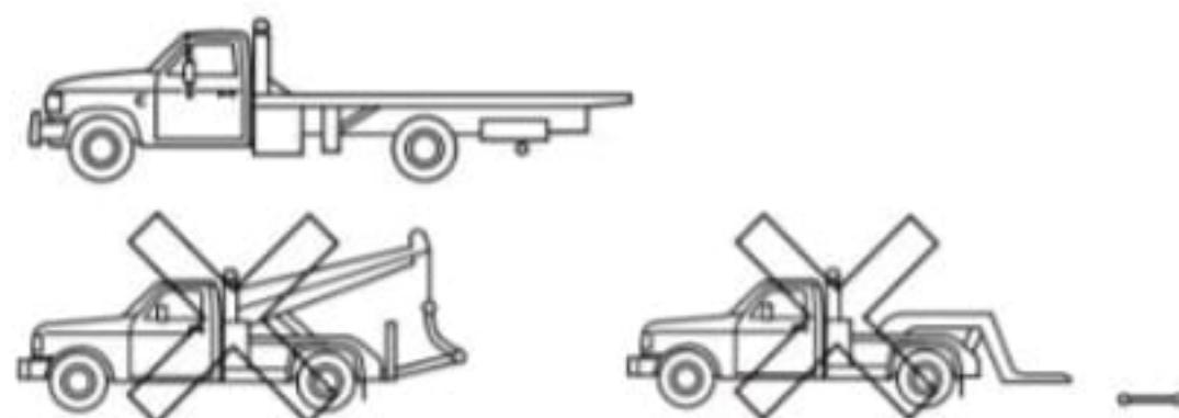
No remolque los vehículos que se hayan visto involucrados en un accidente por sus ejes tractoras. Desactive el sistema de alta tensión (consulte el capítulo 3). Estacione el vehículo a una distancia segura, de al menos 5 m, de los edificios y otros vehículos (zona de cuarentena).
