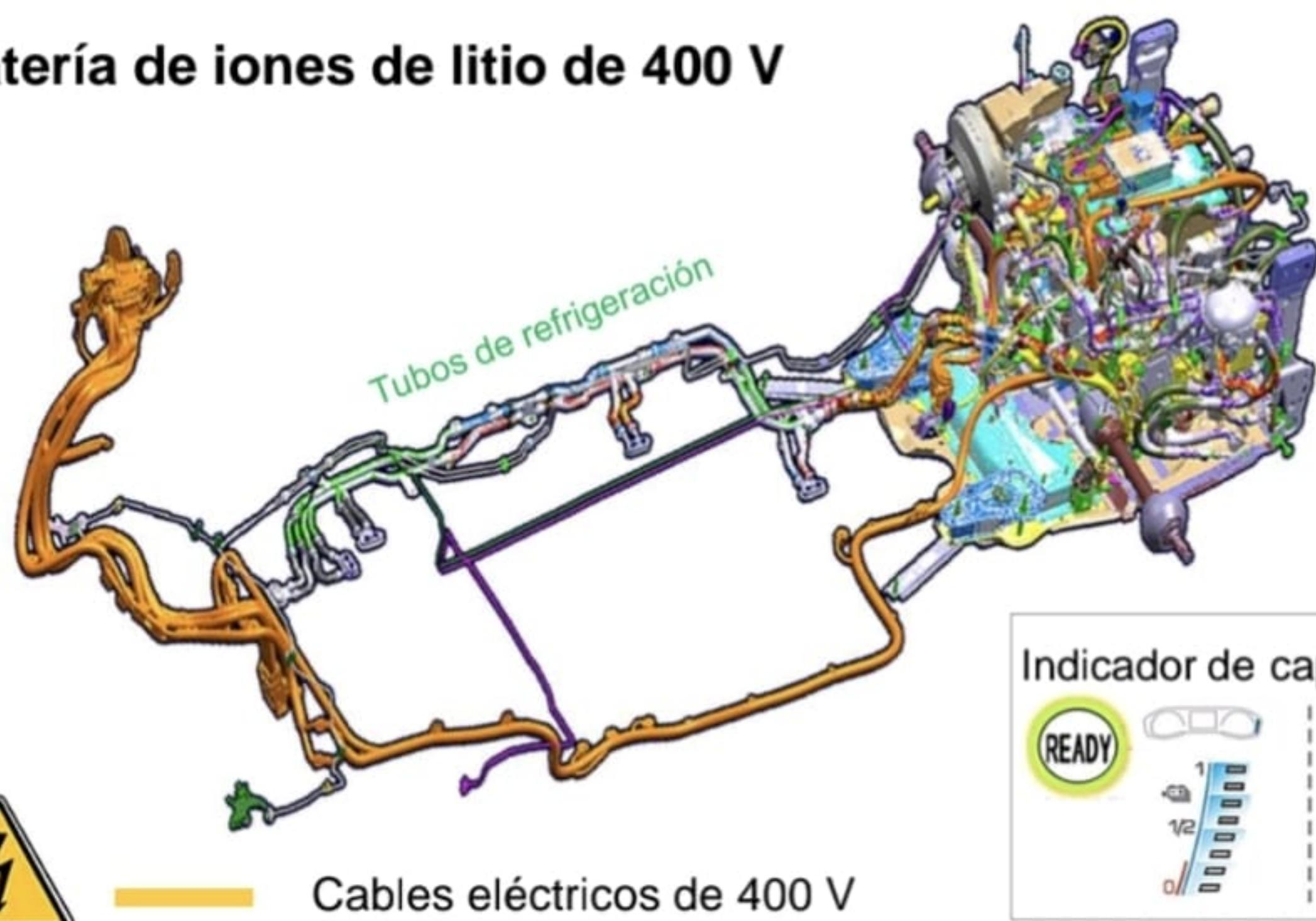
**Conecotor eService** = Dispositivo de corte de alta tensión para equipos de emergencia
