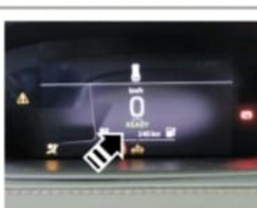
El motor eléctrico es silencioso. El cuadro de instrumentos muestra un mensaje que le indica si el motor eléctrico está apagado "OFF" o listo para su uso "READY".
