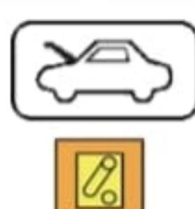
1. El dispositivo de desconexión del alto voltaje está situado en un refuerzo del compartimento del motor.
