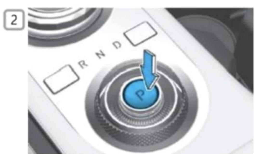
2. Para vehículos automáticos, la palanca de cambios debe estar en la posición de estacionamiento (P).
