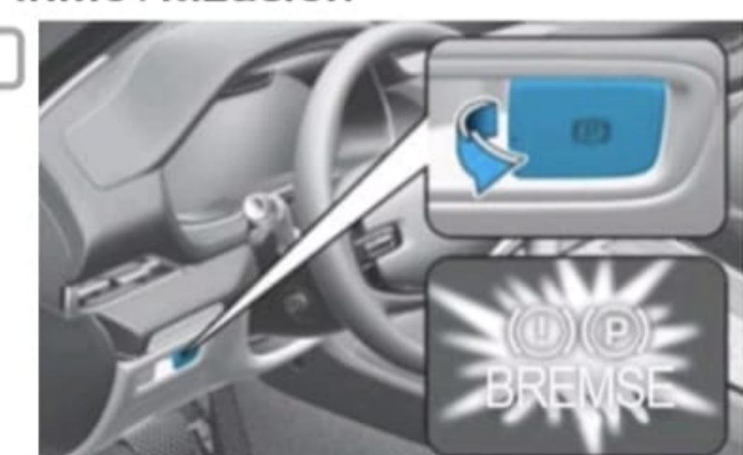
1. Calce las ruedas y tire del interruptor para accionar el freno de estacionamiento.
