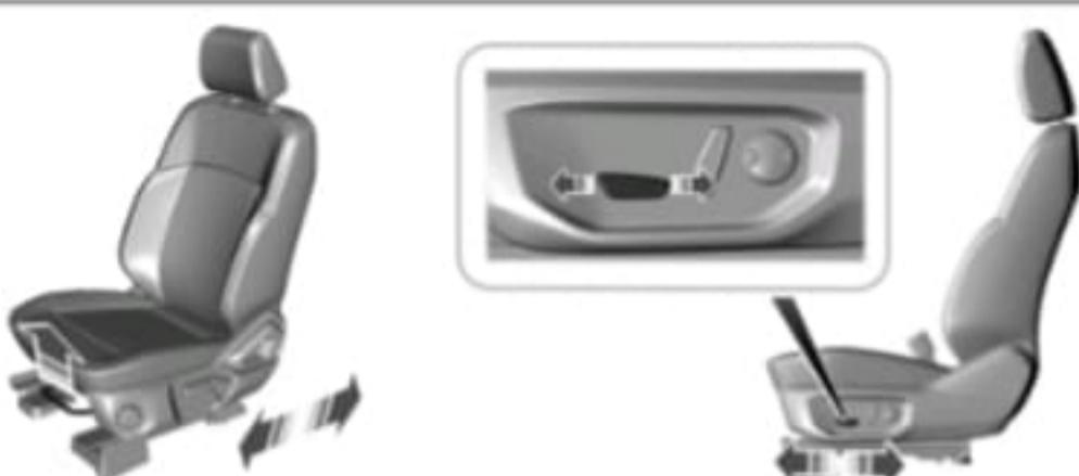
Se requiere energía de la batería para operar el asiento eléctrico.
