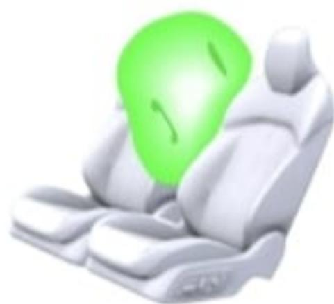
El asiento del conductor tiene un airbag oculto aparte del lateral. La ubicación del airbag oculto se indica con el punto.
