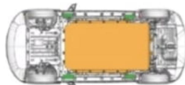
■ Puntos de elevación-estabilización
