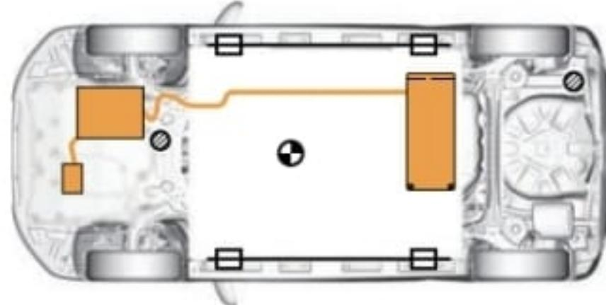
Puntos de elevación reforzados adicionales
