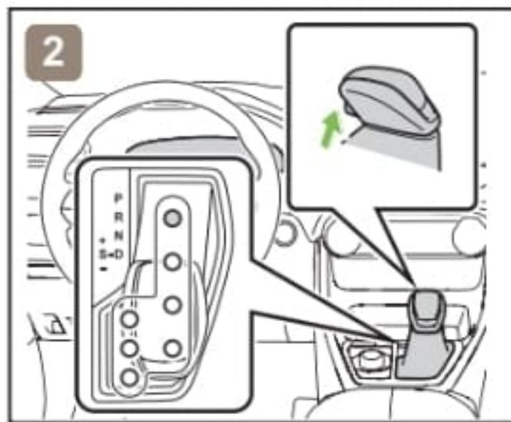
2. Coloque la palanca de cambios en la posición de estacionamiento (P).
