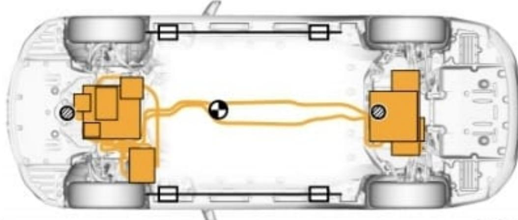
● Puntos de elevación extraforzados
