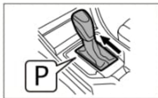
2. Coloque la palanca de cambios en la posición de estacionamiento (P).
