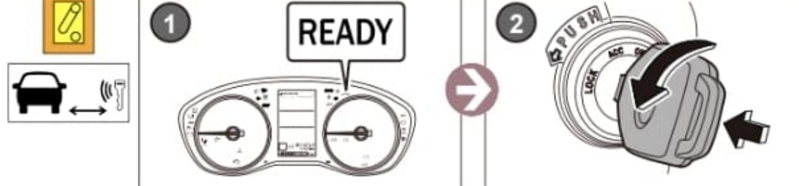
Si no se mueve el interruptor de encendido de la posición "LOCK" (apagado) a la posición "ACC", mueva ligeramente el volante hacia la izquierda y la derecha mientras gira el interruptor de encendido.
