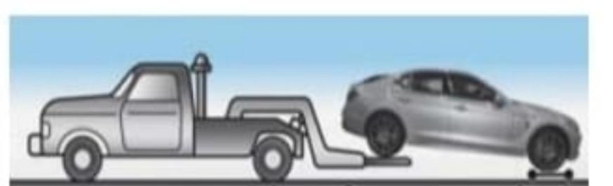
Nota: el vehículo AWD (All Wheel Drive o de tracción integral) debe ser remolcado con todas las ruedas separadas del suelo, ya sea en un camión remolcador de cama baja o utilizando plataformas rodantes.
