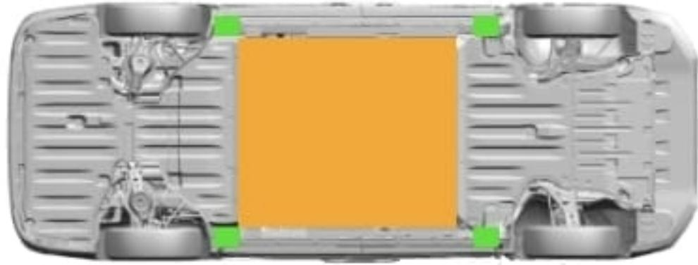
■ Puntos de elevación adecuados ■ Batería de alto voltaje
