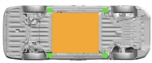
Puntos de elevación adecuados Batería de alto voltaje
