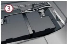
Separación de la estación de carga (desbloqueo de emergencia)
