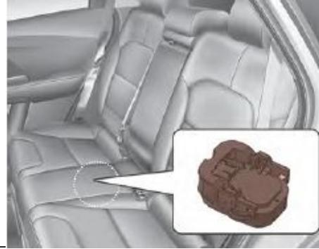
Desconexión física de la Alta Tensión: solo para casos extremos, utilizar guantes de protección eléctrica y máscara facial
