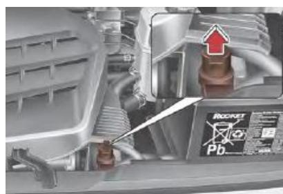
Desbloqueo de emergencia del conector de carga
