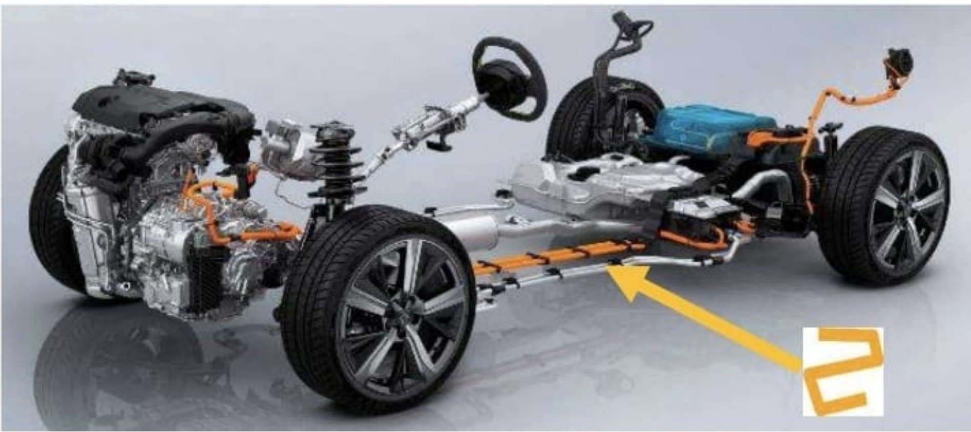
Cableado de alto voltaje
