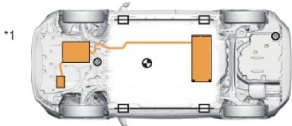
Puntos de elevación extraresforzados
