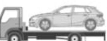
No remolcar un vehículo accidentado haciendo rodar los ejes de accionamiento.
