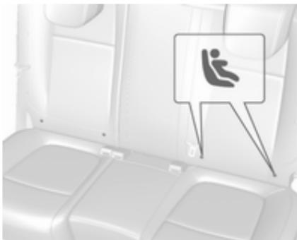
Los soportes de montaje ISOFIX se indican mediante una etiqueta en el respaldo.
