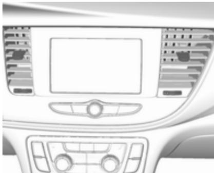
Para abrir la salida de aire, gire la rueda de ajuste hacia la derecha. Ajuste el caudal de aire de la salida de ventilación girando la rueda de ajuste.
