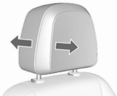
Para ajustarlo horizontalmente, tire del reposacabezas hacia delante. Se enclava en tres posiciones.
