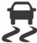
El TC está operativo cada vez que arranca el motor en cuanto se apaga el testigo de control
