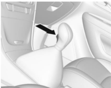
Marcha atrás: con el vehículo parado, pise el pedal de embrague, pulse el botón de desbloqueo de la palanca selectora y engrane la marcha.
