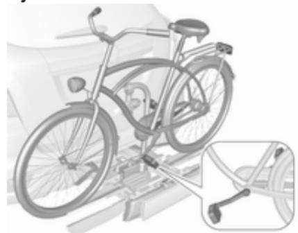
1. Gire los pedales hasta la posición que se muestra en la ilustración y coloque la bicicleta en el alojamiento para las ruedas.
