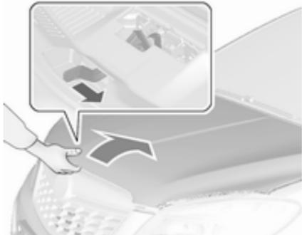
Mueva el cierre de seguridad hacia los lados, hacia el lateral izquierdo del vehículo y abra el capó.
