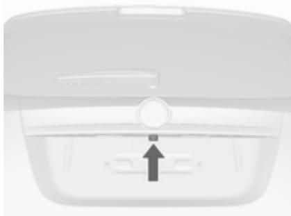
La cámara está montada en el tirador del portón trasero y ofrece un ángulo de visión de 130°.
