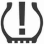
Si se detecta un problema de presión baja de los neumáticos, se indica mediante el testigo de control
