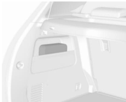
Guarde el botiquín en el compartimento portaobjetos que hay en la pared lateral izquierda del compartimento de carga.
