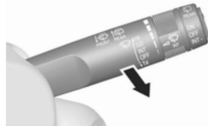
Tire de la palanca. Se pulveriza líquido de lavado sobre el parabrisas y el limpialuneta se realiza el barrido varias veces.
