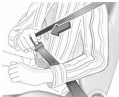
Extraiga el cinturón del retractor, guíelo por encima del cuerpo sin retorcerlo e inserte la lengüeta en el cierre.
