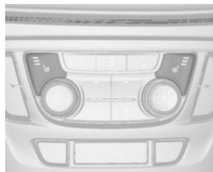
Para ajustar la potencia de calefacción deseada, pulse una o varias veces del asiento correspondiente. El LED del botón indica la configuración.
