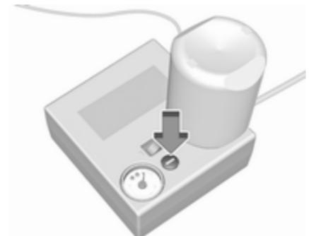
Si la presión de los neumáticos prescrita no se alcanza en un plazo de diez minutos, desconecte el juego de reparación de neumáticos. Haga girar el neumático una vuelta completa. Vuelva a conectar el juego de reparación
