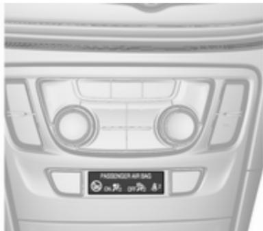
En caso de colisión, el sistema de airbag del asiento del acompañante se inflará siempre que el testigo de control **OFF**  no esté encendido.
