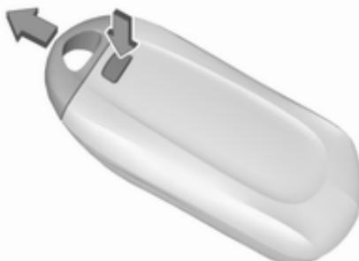
1. Pulse el botón de la parte posterior de la unidad de la llave electrónica y saque la hoja de la llave de la carcasa.
