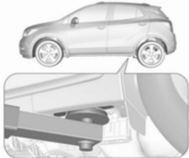
Posición del brazo trasero de la plataforma elevadora centrado bajo el rebaje del estribo.
