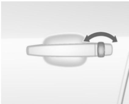
Desbloquee manualmente la puerta del conductor introduciendo y girando la llave en el cilindro de la cerradura.
