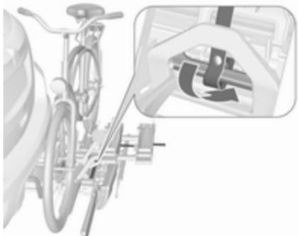
4. Pase la correa del adaptador por debajo de la palanca cuando pliegue el portabicicletas trasero. Abroche la correa.
