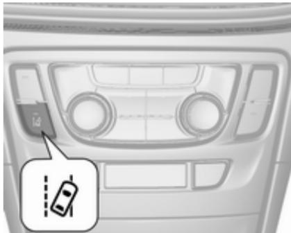
El sistema de aviso de cambio de carril se activa pulsando . El LED encendido en el botón indica que el sistema está conectado.
