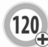
Además, el límite de velocidad actualmente válido se muestra permanentemente en la línea inferior del centro de información del conductor. Si ha disponible un límite de velocidad con adición, se muestra un símbolo + en este área.
