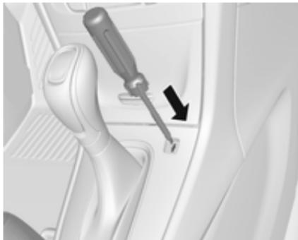
3. Inserte un destornillador en la abertura hasta el tope.
