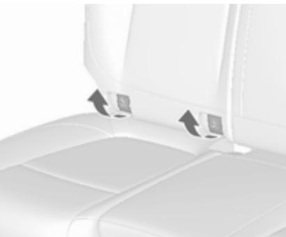
Las cubiertas de las guías bascularán hacia atrás automáticamente al acoplar el sistema de retención infantil.
