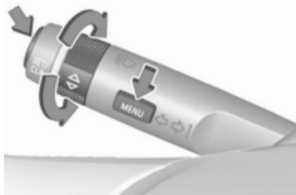
Pulse **MENU** para cambiar entre los menús principales o para volver de un submenú al siguiente nivel superior del menú.
