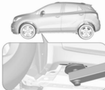
Posición del brazo delantero de la plataforma elevadora en los bajos.
