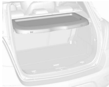
No coloque ningún objeto sobre la cubierta.
