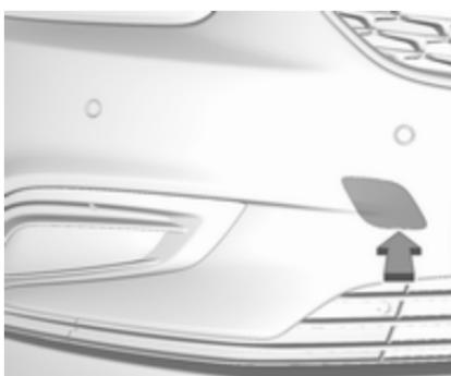
Desenclave la tapa con un destornillador y desmóntela.
