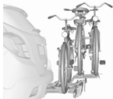
El portabicicletas trasero (sistema Flex-Fix) ofrece la posibilidad de fijar una bicicleta en un soporte extensible integrado en el piso del vehículo. Se pueden sujetar dos bicicletas más en un adaptador. No se pueden transportar otros objetos.
