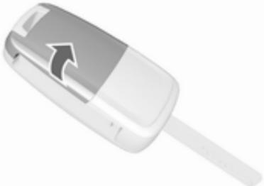
Despliegue la llave y abra la unidad. Sustituya la pila (tipo CR 2032), prestando atención a la posición de montaje. Cierre la unidad y sincronice el mando a distancia.
