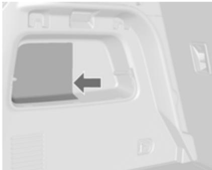
2. Suelte primero la tapa introduciendo un destornillador por la ranura. Luego suelte la tapa en el lado frontal y superior. Desmonte la tapa.
