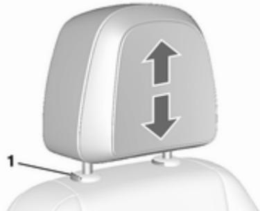
Tire del reposacabezas hacia arriba. Pulse el resorte (1) para desbloquearlo y empuje el reposacabezas hacia abajo.
