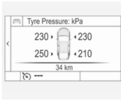
6. Pulse **SET/CLR** para empezar el proceso de emparejamiento de los sensores. Debería visualizarse un mensaje solicitando la aceptación del proceso.
