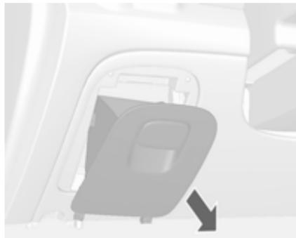
El bloque de fusibles interior está situado en la parte inferior del tablero de instrumentos, en el lado del conductor. Para acceder a los fusibles, desmonte el portaobjetos. Para desmontar el portaobjetos, ábralo y tire de él.
