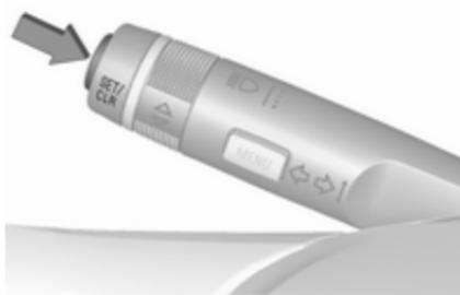
Cuando se muestre la página del asistente de señales de tráfico, pulse SET/CLR en la palanca del intermitente.
