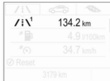
Seleccione pulsando **Menu** en la palanca de los intermitentes. Gire la rueda de ajuste y seleccione o . Cada página de cuentakilómetros parcial se puede poner a cero de manera independiente pulsando **SET/CLR** en la palanca de los intermitentes durante unos segundos en el menú correspondiente.
