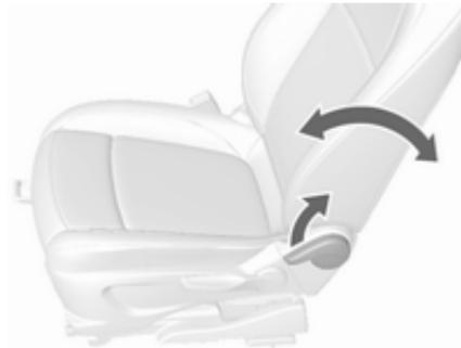
Tire de la palanca, ajuste la inclinación y suelte la palanca. Deje que el respaldo enclave audiblemente.
