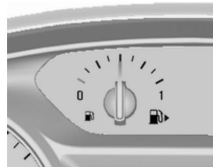
Muestra el nivel en el depósito de combustible o gas, según el modo de funcionamiento.
