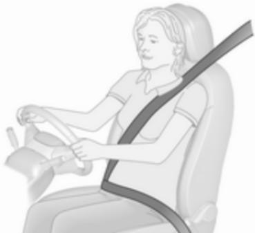
Al acelerar o frenar bruscamente el vehículo, los cinturones de seguridad se bloquean para sujetar a los ocupantes en la posición del asiento. Por lo tanto, se reduce considerablemente el riesgo de lesiones.
