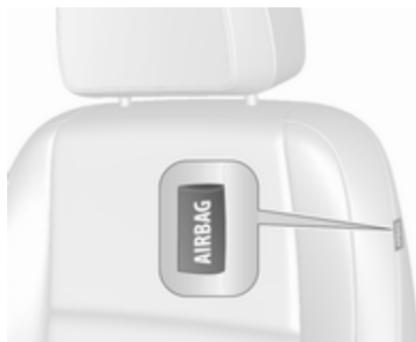
El sistema de airbags laterales se compone de un airbag en cada respaldo de los asientos delanteros. Se pueden identificar por el rótulo **AIRBAG**.
