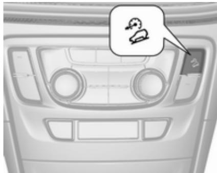
A velocidades inferiores a aproximadamente 40 km/h, pulse . El testigo de control verde parpadea en el cuadro de instrumentos para indicar que el DCS está operativo. El DCS no se activará a velocidades superiores a 50 km/h aunque se pulse el botón.
