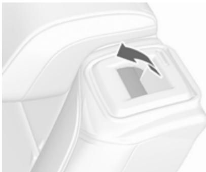
3. Tire de la palanca de desbloqueo en la parte superior del respaldo trasero.
