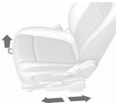
Tire del asidero, deslice el asiento, suelte el asidero. Intente mover el respaldo hacia delante y hacia atrás para asegurarse de que el asiento está bloqueado en su posición.
