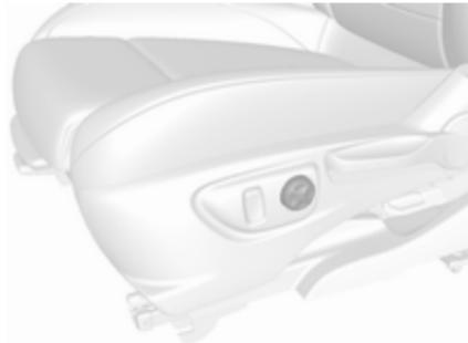
Ajuste el apoyo lumbar con el comutador de cuatro posiciones para adaptarlo a sus necesidades personales.
