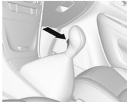
Para aplicar la marcha atrás, con el vehículo parado, pise el pedal de embrague, pulse el botón de desbloqueo de la palanca selectora y engrane la marcha.
