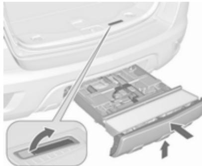
Tire de la palanca de desbloqueo hacia arriba y manténgala. Suba ligeramente el sistema e intodúzcalo en el parachoques hasta que quede enclavado.
