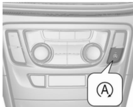
Desactive manualmente el sistema stop-start pulsando A. La desactivación se indica cuando el LED del botón se apaga.
