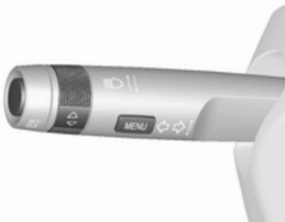
Pulse **SET/CLR** en la palanca de intermitentes para confirmar un mensaje.
