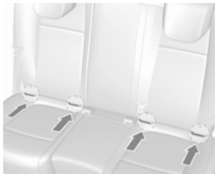
Fije los sistemas de seguridad infantil ISOFIX homologados para el vehículo a los soportes de montaje ISOFIX. Las posiciones específicas del vehículo para los sistemas de retención infantil ISOFIX están marcadas mediante "IL" en la tabla.
