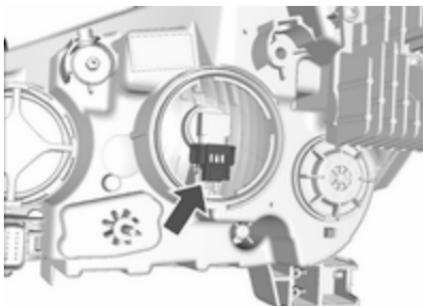
4. Desconecte el conector del mazo de cables de la bombilla.
