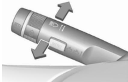
Pulse la palanca para cambiar de luz de cruce a luz de carretera.
