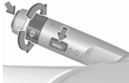
Seleccione mediante **MENU** y seleccione la página del asistente de señales de tráfico con la rueda de ajuste en la palanca del intermitente 105.
