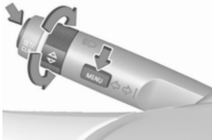
En la pantalla de nivel intermedio seleccione el menú **Opción** pulsando **MENU** en la palanca del intermitente. Gire la rueda de ajuste para seleccionar la página **Índice del est. útil del aceite**.
