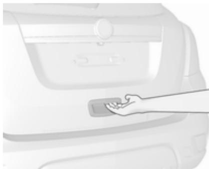
Después del desbloqueo, pulse el interruptor con superficie táctil y abra el portón trasero.
