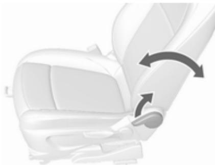
Tire de la palanca, ajuste la inclinación y suelte la palanca. Deje que el asiento enclave audiblemente.
