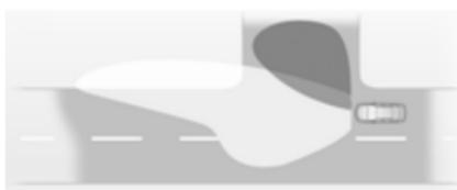
En giros cerrados o cruces, dependiendo del ángulo de la dirección o de los intermitentes, se conecta un reflector adicional en el lado izquierdo o derecho que ilumina la carretera en la dirección de marcha. Se activa hasta una velocidad máxima de 70 km/h.
