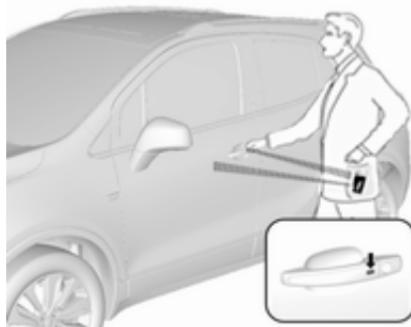
La llave electrónica debe estar fuera del vehículo a una distancia máxima de un metro aproximadamente del lado de la puerta correspondiente.
