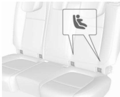
El vehículo podría estar equipado con guías delante los soportes de montaje para permitir el montaje del sistema de retención infantil.
