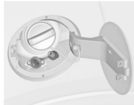
Enrosque a mano el adaptador requerido en la boca de llenado.
