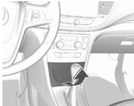
Hay una toma de corriente de 12 V situada en la consola delantera detrás de la cubierta. Para abrirlo, pulse el botón.
