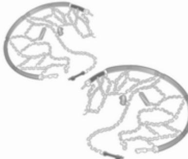
Sólo se pueden utilizar cadenas para nieve en las ruedas delanteras.
