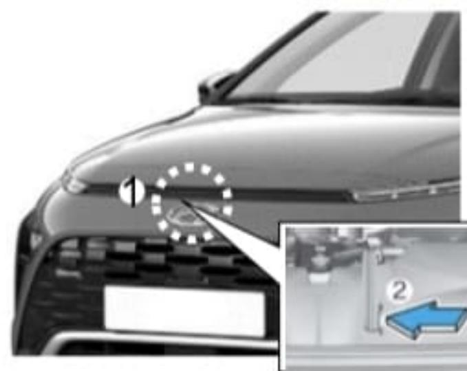
Eleve ligeramente el capó, tire del enganche (1) situado en el interior del centro del capó y levante el capó (2)
