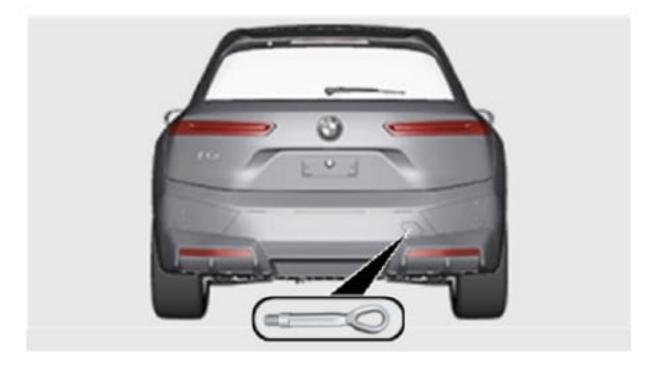
Por lo general, se permite retirar el vehículo de las inmediaciones de la zona de peligro a una velocidad similar al paso humano. Solo se permite el transporte en camión. Se prohíbe cualquier otra forma de remolcar el vehículo. Se recomienda asegurar el vehículo a través de sus ruedas.
