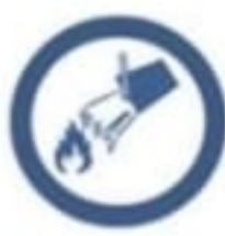
En caso de incendio en la batería de alto voltaje, apáguelo con agua y deje que se enfrie dejando que entre tanta agua como sea posible en la batería.
