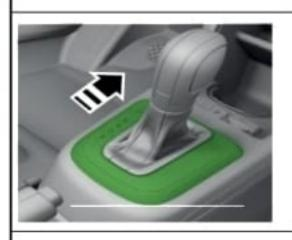
Transmisión automática Lleve la palanca de marcha a la posición "P".
