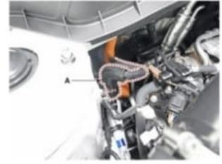
Gire la llave de contacto a la posición OFF y desconecte el conector positivo (+) de la batería auxiliar de 12V (+) (A).
