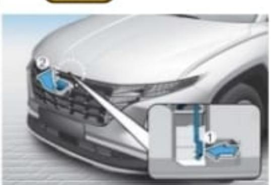
Tire de la palanca de liberación. El capó debería abrirse ligeramente.
