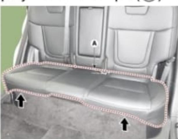
Gire la llave de contacto a la posición OFF y desconecte el conector positivo (+) de la batería auxiliar de 12V (+) (A).
