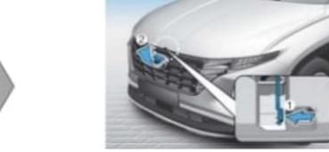
Levante ligeramente el capó, empuje el pestillo secundario hacia arriba (1) en el centro del capó y levante el capó (2)
