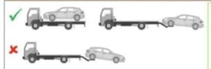
No remolcar el vehículo accidentado por el eje de tracción.
