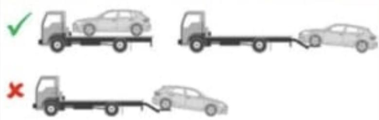
No remolcar el vehículo accidentado por el eje de tracción.
