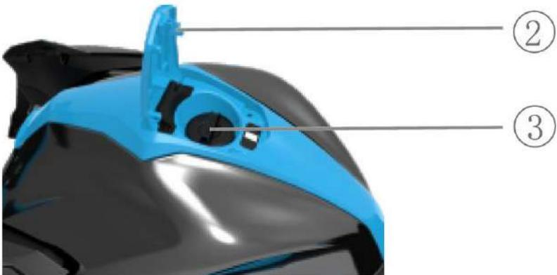
El depósito de gasolina se encuentra delante del asiento. Para repostar gasolina deberá abrir la tapa de acceso al tapón. Asegúrese de que el motor esté parado, y pulse el botón del depósito de gasolina (1), la tapa (2) se abrirá automáticamente, gire el tapón (3) del depósito de gasolina en sentido antihorario. Para cerrar el depósito, siga el orden opuesto al descrito.
