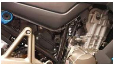
5. Retire los dos tornillos Allen que fijan la base posterior del asiento.
