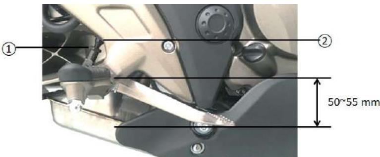
1. Afloje la contratuerca (1), gire el tornillo (2), el pedal de freno debe encontrarse 50-55 mm por debajo de la punta del pie derecho.
