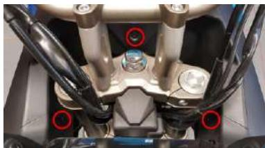
2. Retire la fijación por delante de la tija.
