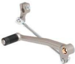
La motocicleta cuenta con un cambio de seis velocidades, su funcionamiento es el siguiente. Seleccione la velocidad deseada moviendo hacia arriba o abajo la palanca de cambios; la palanca de cambios se recuperará a su posición original, para un cambio posterior.
