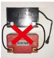
No conecte una batería en paralelo
