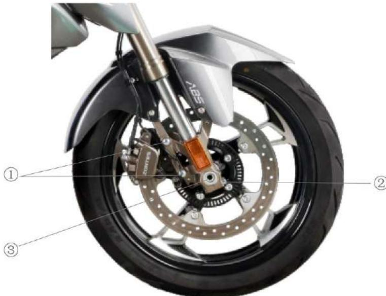
Par de apriete del eje delantero: 65 Nm
