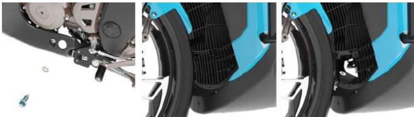
6. Por el orificio de llenado debe introducir 1.600 ml de aceite motor nuevo SAE 10W-40/10W-50 API nivel SM o superior para motocicleta 4 tiempos añadido en dos etapas: en la primera rellene la mitad de esa cantidad, luego apriete la varilla de nivel, arranque el motor durante 2 minutos, y luego rellene con el resto.
