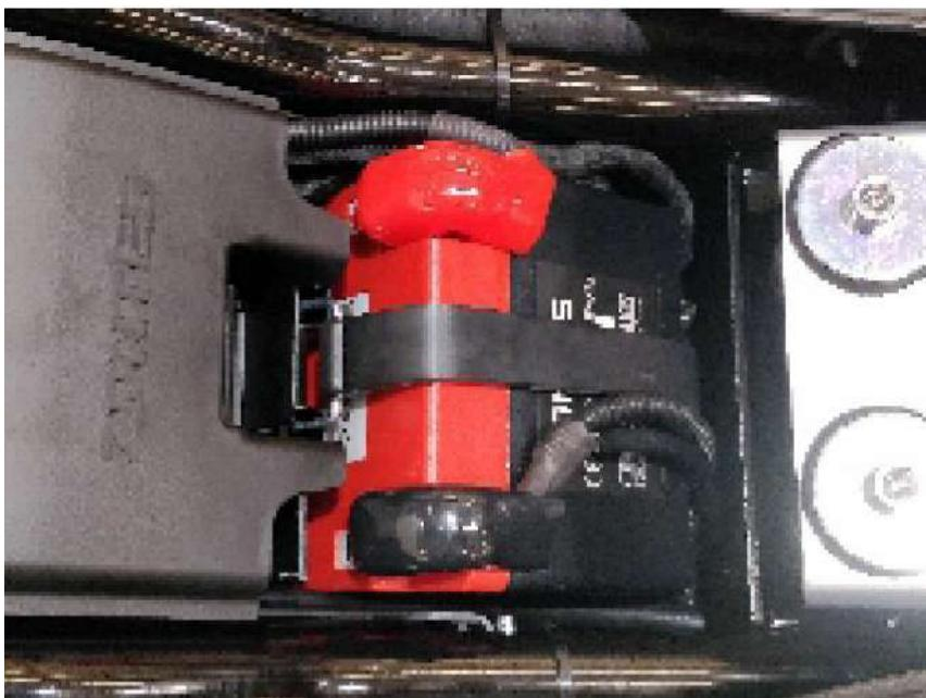
La batería se encuentra debajo del asiento del piloto. Se trata de una batería de litio sin mantenimiento. Haga la primera carga con un cargador específico para batería de litio. Después de montarla, está lista para su uso.
