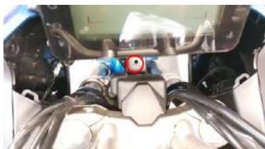
3. Se procede a retirar la moldura plástica que cubre los tubos del bastidor. Esta se fija a través de 4 tetones de unión que se desmontan por simple presión.
