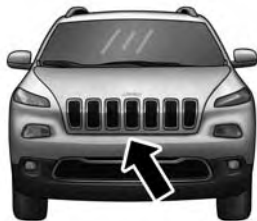
Ubicación de la palanca de liberación del pestillo de seguridad del capó
