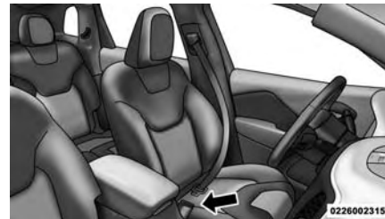
Insertión de la placa de cierre en la hebilla
