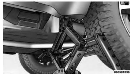
Posición trasera de elevación con gato
