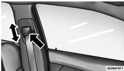
Anclaje superior de cinturón de hombro ajustable
