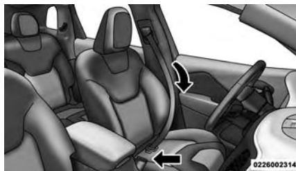
Retiro de la placa de cierre del cinturón de seguridad de tres puntos
