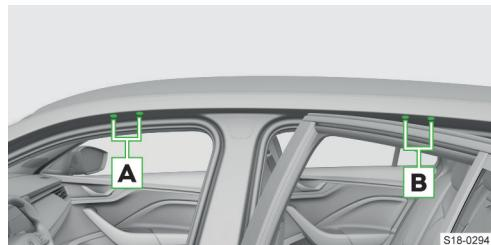
Los travesaños de techo pueden fijarse dependiendo del equipamiento en los puntos de fijación **A** y **B**.
