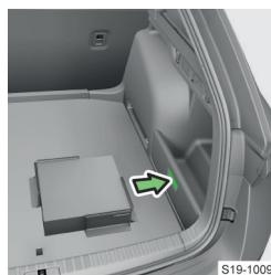
La carga máxima de los elementos de carga es de 8 kg.
