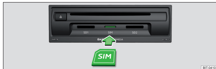
Fig. 189 Introducir la tarjeta SIM en el módulo externo
