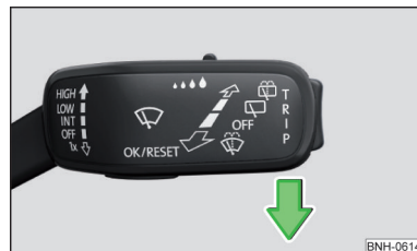
Fig. 328 Ajustar la posición de servicio de los brazos del parabrisa
