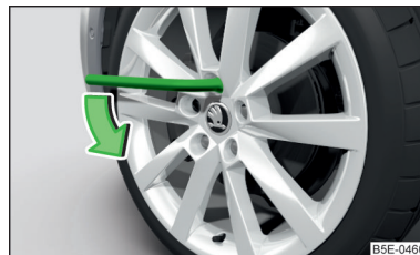
Fig. 313 Aflojar los tornillos de rueda
