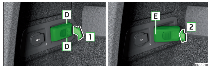
Fig. 145 Retirar la lámpara / Introducir la lámpara
