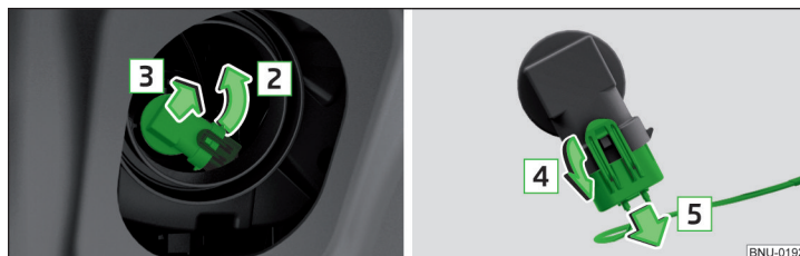
Fig. 342 Cambiar la bombilla del faro antiniebla
