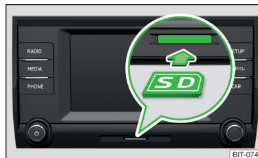
Fig. 181 Swing: Introducir tarjeta SD
