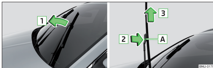
Fig. 329 Cambiar la escobilla limpiacrystal del parabrisas
