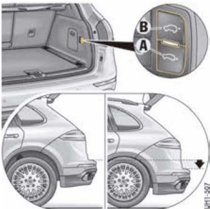
Ajuste del nivel de carga mediante teclas en el maletero
